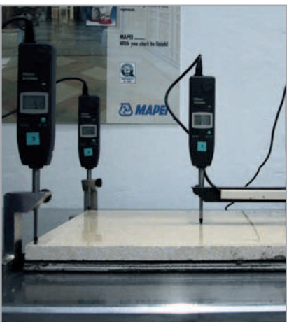
2.3 ábra – Gyorskötésű ragasztóanyaggal bevont kőlapon végzett méretstabilitási szimulációs teszt
