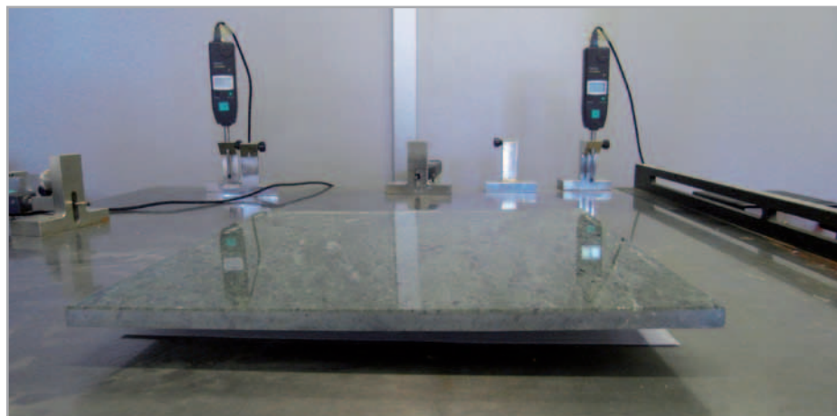
2.1 ábra – Nedvességre érzékeny kőből készült burkolólap vetemedése
